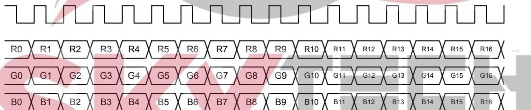
Figure 6-14 RGB 8:8:8 (Max. 100MHz)
